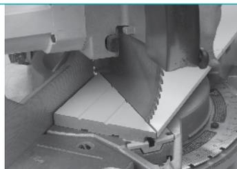
Após o corte, guarde o pedaço pequeno que sobrou, pois esta peça será usada no acabamento de topo do rodapé.
