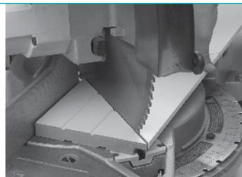
Após o corte, guarde o pedaço pequeno que sobrou, que deve ter um lado cortado em 45° e outro lado em 90°, pois esta peça será usada para o acabamento de topo do rodapé.
