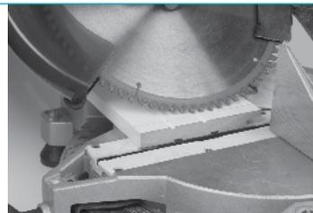
Após o corte, guarde o pedaço pequeno que sobrou, que deve ter um lado cortado em  $45^\circ$  e outro lado em  $90^\circ$ , pois esta peça será usada para o acabamento de topo do rodapé.
