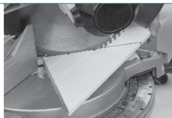
Una as 2 partes cortadas em ângulo com cola PVA resistente à umidade.
