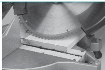
A distância do corte deve ser exatamente a espessura da barra, ou seja, 18 mm.
