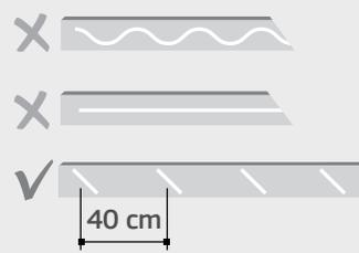
Fixe o rodapé na parede exercendo pressão, de forma que o adesivo tenha contato com ambas as superfícies. Se precisar, dê leves batidas com o martelo de borracha para ajustar.
